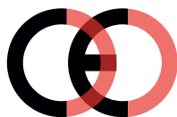
Falsk CE-mærke (for tæt på hinanden)
